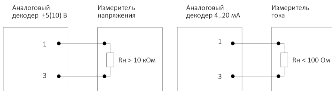
Рисунок 20 - Схема подключения декодера Т24 и блока индикации Т42.
