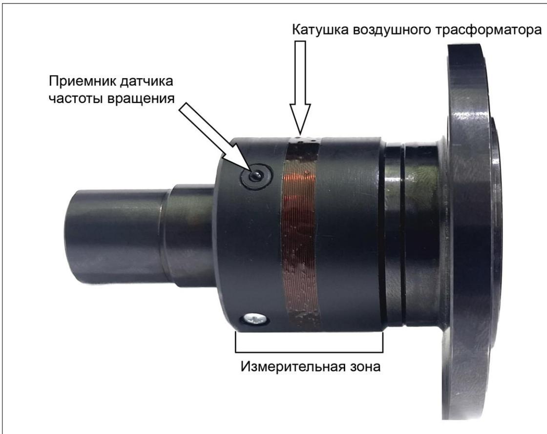
Рис. 2 – Ротор датчика M40A
