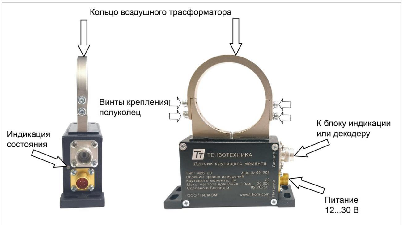
Рис. 3 – Статор датчика M26
