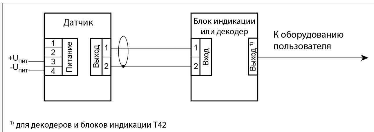
Рис. 9 – Схема подключения датчика М25 к вторичным устройствам
