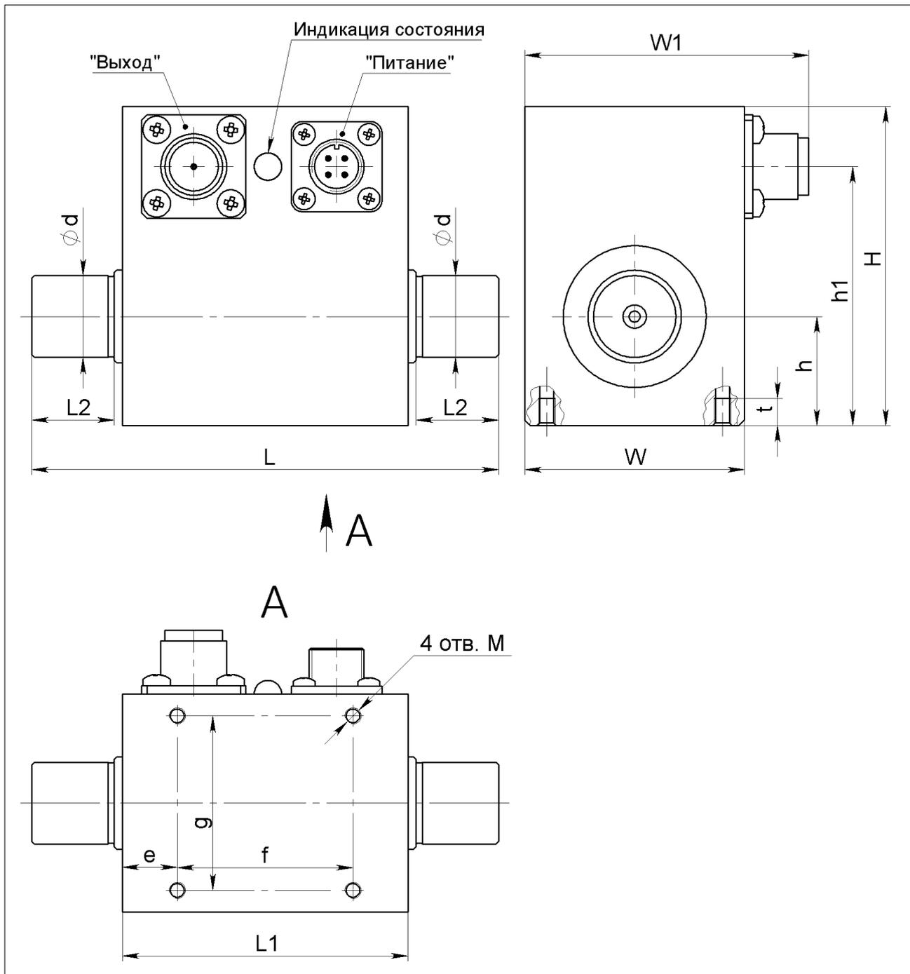
Рис. 3 – Датчики М25-5...М25-300. Габаритные и установочные размеры, мм
