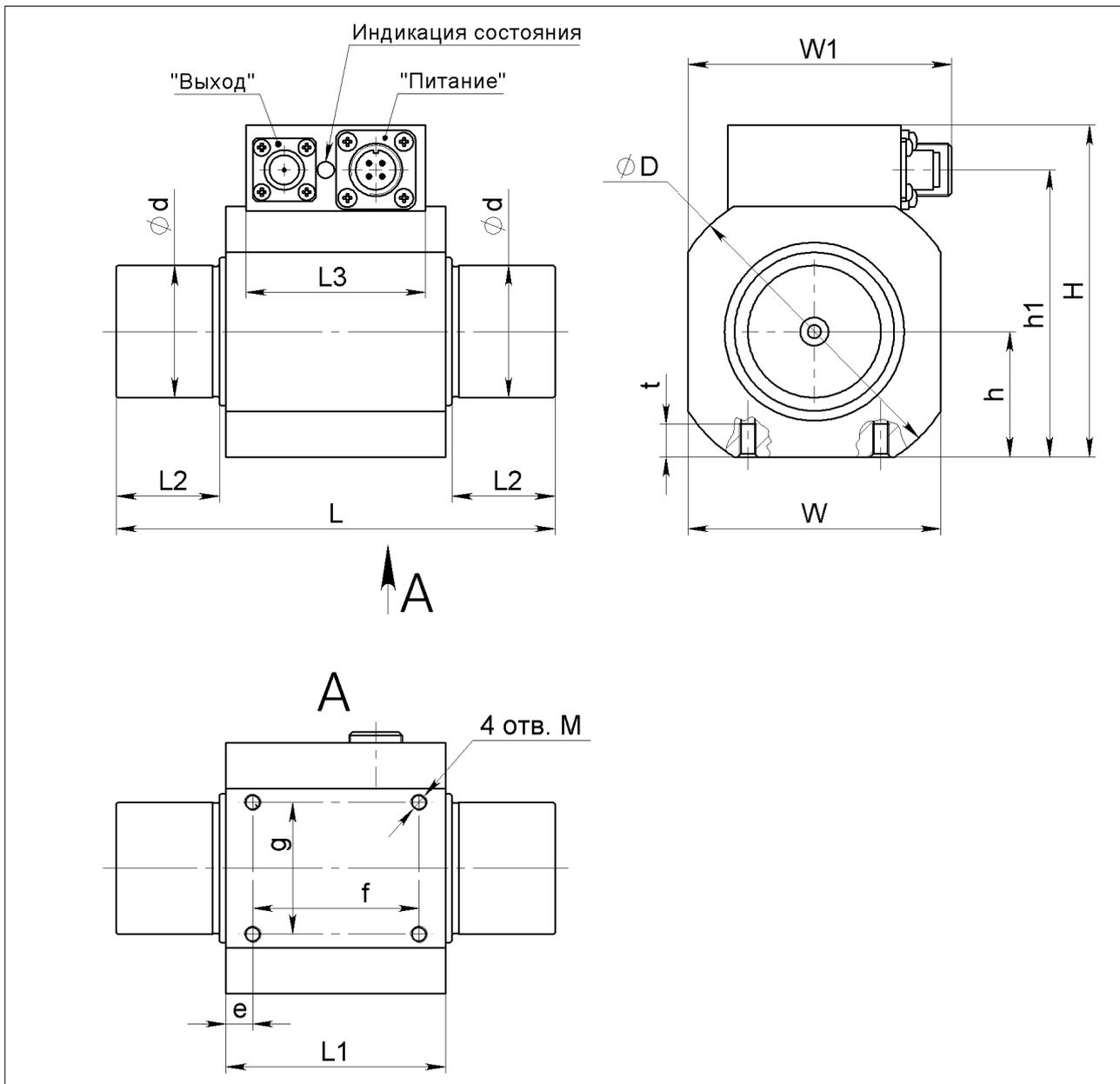
Рис. 4 – Датчики M25-400...M25-2к. Габаритные и установочные размеры, мм
