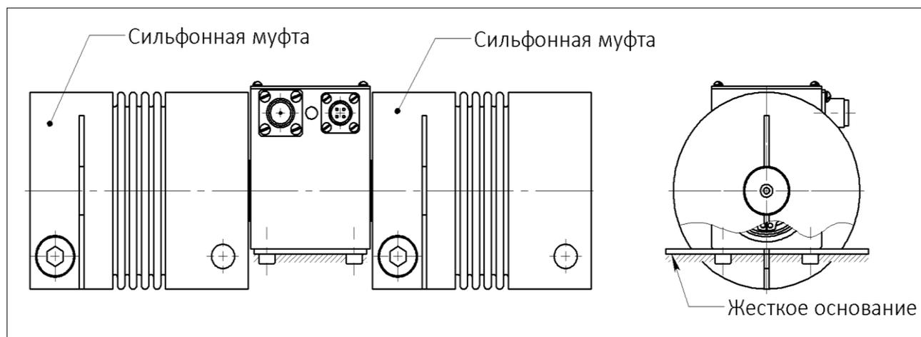
**Рис. 5** – Установка датчика М25 с применением сильфонных муфт
