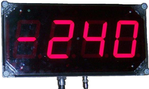
Блок индикации Т50 предназначен для работы совместно с датчиками силоизмерительными, весоизмерительными, крутящего момента для отображения измеряемых величин, силы (веса), крутящего момента.
